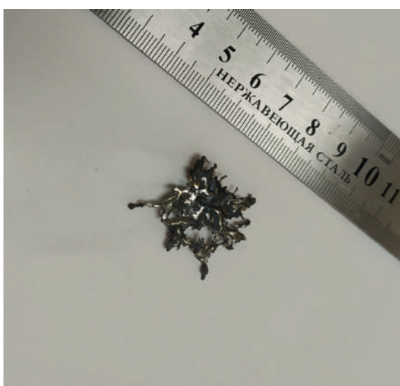
Рис. 2. Слиток алюминия, образовавшийся при воспламенении одного из аккумуляторных элементов 18650
