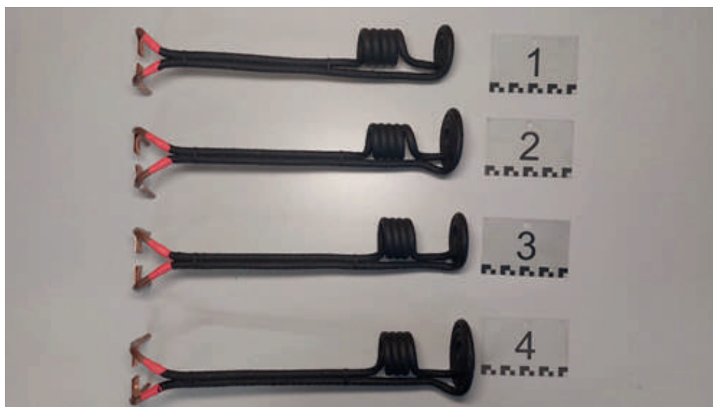
Рис. 3. Индукторы с наибольшей эффективностью
