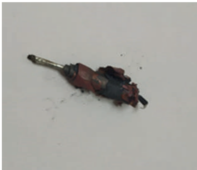
Рис. 1. Внешний вид сердечника после «отстрела» из воспламенившегося аккумуляторного элемента 18650
