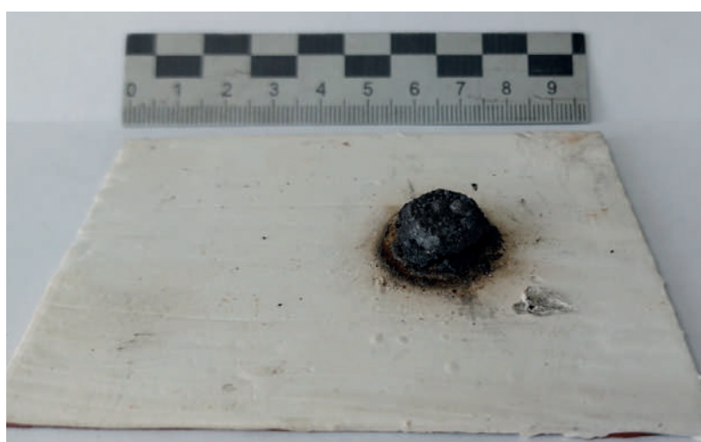
Рис. 4. Огнезащитное покрытие после проведенных испытаний
